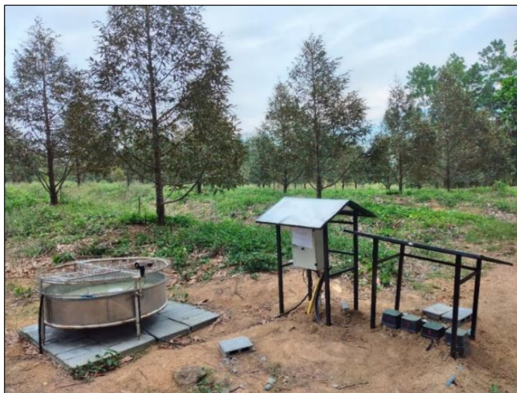
ภาพที่ 3 ทดสอบระบบควบคุมอัตโนมัติการให้น้ำทุเรียนโดยใช้ค่าจากสภาพวัดระเหย (Epan) ในแปลงปลูกพื้นที่จังหวัดจันทบุรี
