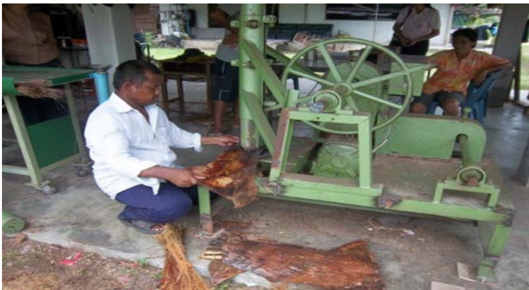
เครื่องทุบและเครื่องตีเส้นใยตาล
