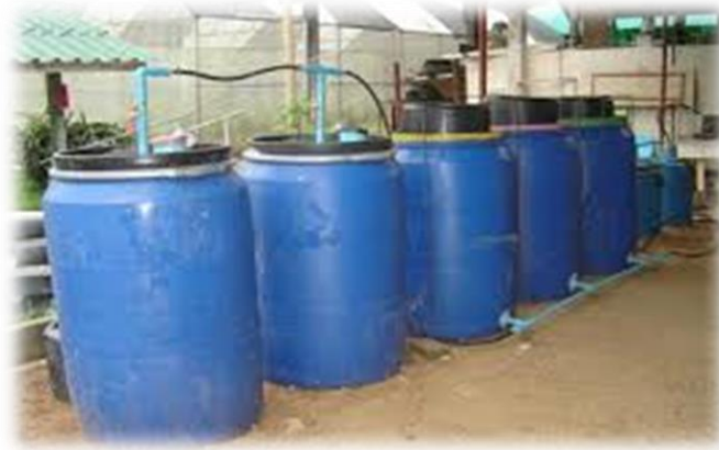
ภาพที่ 3.2 การผลิตก๊าซชีวภาพแบบถังลอย (Floating Drum Digester)
