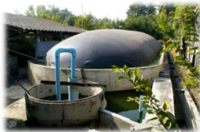
ภาพที่ 3.3 การผลิตก๊าซชีวภาพแบบถุงหมักก๊าซ (PVC Biogas Bag)
