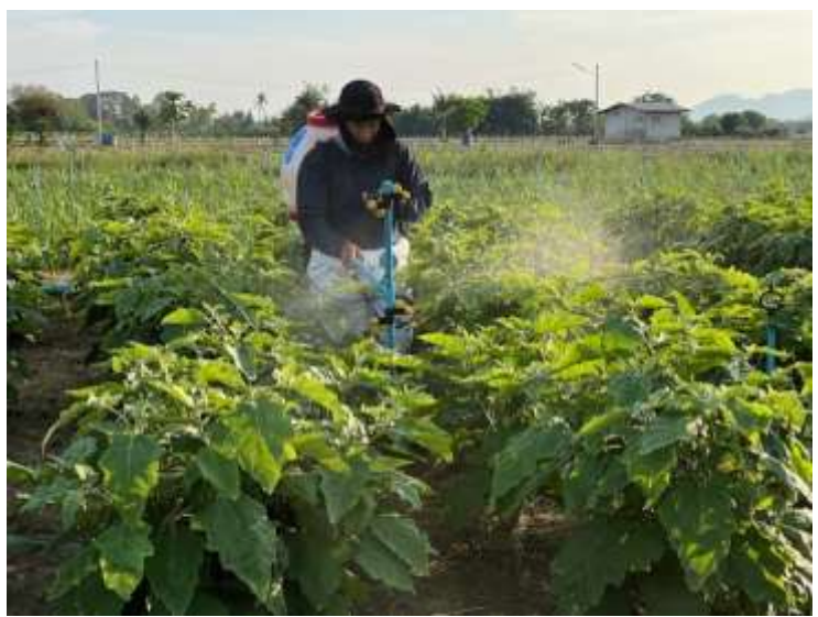
ภาพที่ 2 การพ่นสารด้วยเครื่องยนต์พ่นสารสะพายหลังแบบแรงดันน้ำสูง ประกอบก้านฉีดแบบคานคู่ แนวตั้ง 2 ด้าน ใช้หัวฉีดแบบพัด
