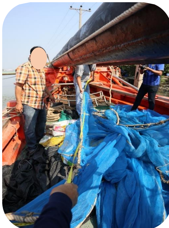
ภาพที่ ๖๙ การวัดความยาวคร่าวล่างของอวนรุนเคย
