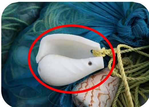
ภาพที่ ๗๘ ลักษณะของเครื่องมือลอบหมึกสายเปลือกหอยเทียม (พลาสติก)
