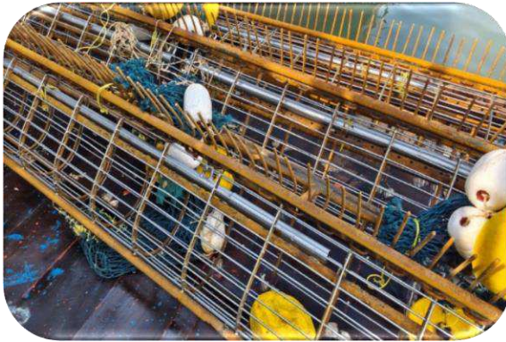
ภาพที่ ๓๘ ลักษณะของคราดปลิงทะเลแบบตะแกรงซี่คราด
