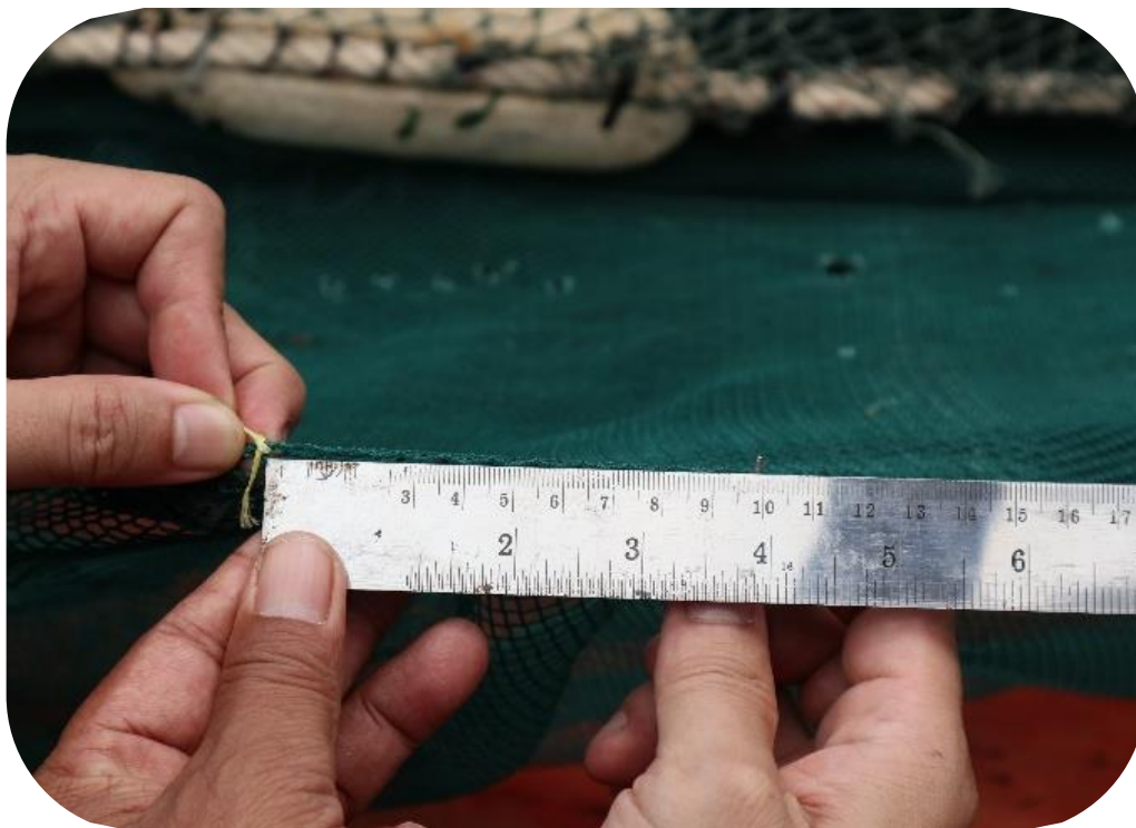
ภาพที่ ๕๙ การวัดขนาดตาอวนของเครื่องมืออวนครอบปลาตะกัก
