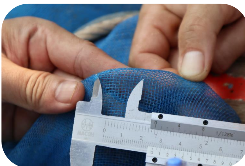
ภาพที่ ๖๗ การวัดจากด้านหนึ่งไปจนถึงด้านตรงข้ามเป็นระยะ ๑ นิ้ว
