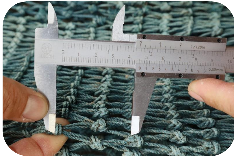
ภาพที่ ๑๗ การวัดขนาดตาอวนกันถูง ๑ ตา (วัดจากกึ่งกลางปมด้านหนึ่งถึงกึ่งกลางปมอีกด้านหนึ่ง)
