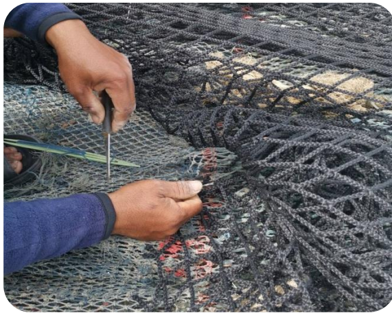
ภาพที่ ๓๑ จุดที่มีการเย็บอวนกันถุงเพื่อเชื่อมต่อกับตาพริของตัวอวน (เช่นเดียวกับภาพที่ ๑๕) ที่ถูกคลุมด้วยอวนรองกันถุง
