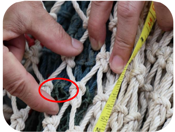
ภาพที่ ๓๑ จุดที่มีการเย็บอวนกันถุงเพื่อเชื่อมต่อกับตาพริของตัวอวน (เช่นเดียวกับภาพที่ ๑๕) ที่ถูกคลุมด้วยอวนรองกันถุง
