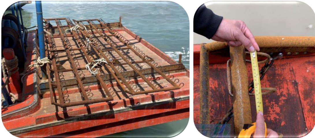
ภาพที่ ๔๐ ลักษณะของคราดปลิงทะเลแบบตะแกรงตะขอ
