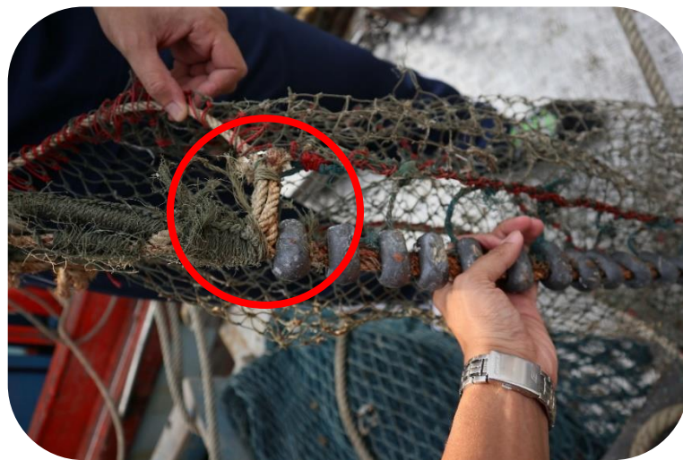
ภาพที่ ๒๓ จุดที่มีการเย็บเนื้ออวนให้ติดกับเชือกคร่าวล่าง
