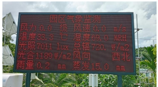
สถานีตรวจวัดสภาพแวดล้อมของพื้นที่เพาะปลูก มีจอแสดงผลกำลังและความเร็วลม อุณหภูมิ ความชื้น แสง ปริมาณน้ำฝน ฯลฯ
