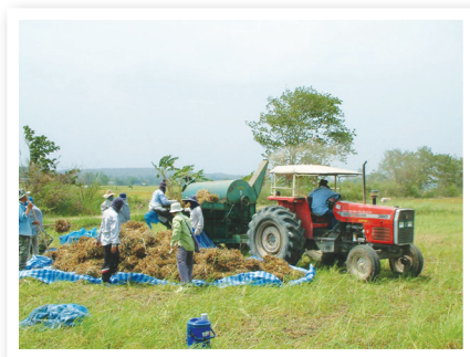
การนวดข้าวเปลือกด้วยเครื่อง ที่พัฒนามาจากเครื่องนวดข้าว
