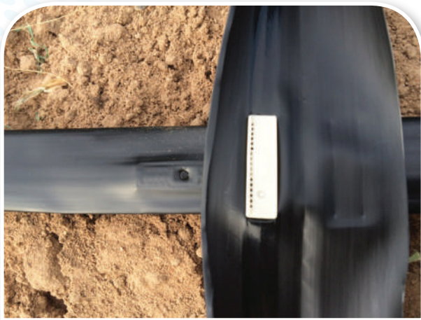
ภาพที่ 35 เทปน้ำหยดและแผ่นบังคับน้ำด้านในเทปน้ำหยด
