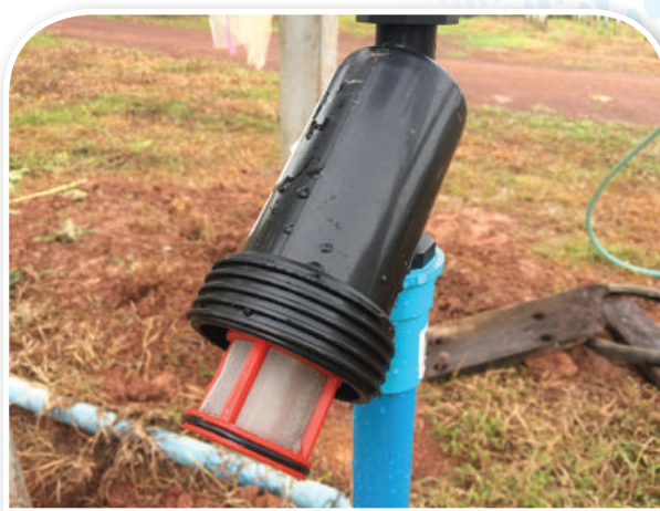
ภาพที่ 41 กรองเกสรแบบตะแกรง ใ้กรองสีแดงความละเอียด 120 Mesh
