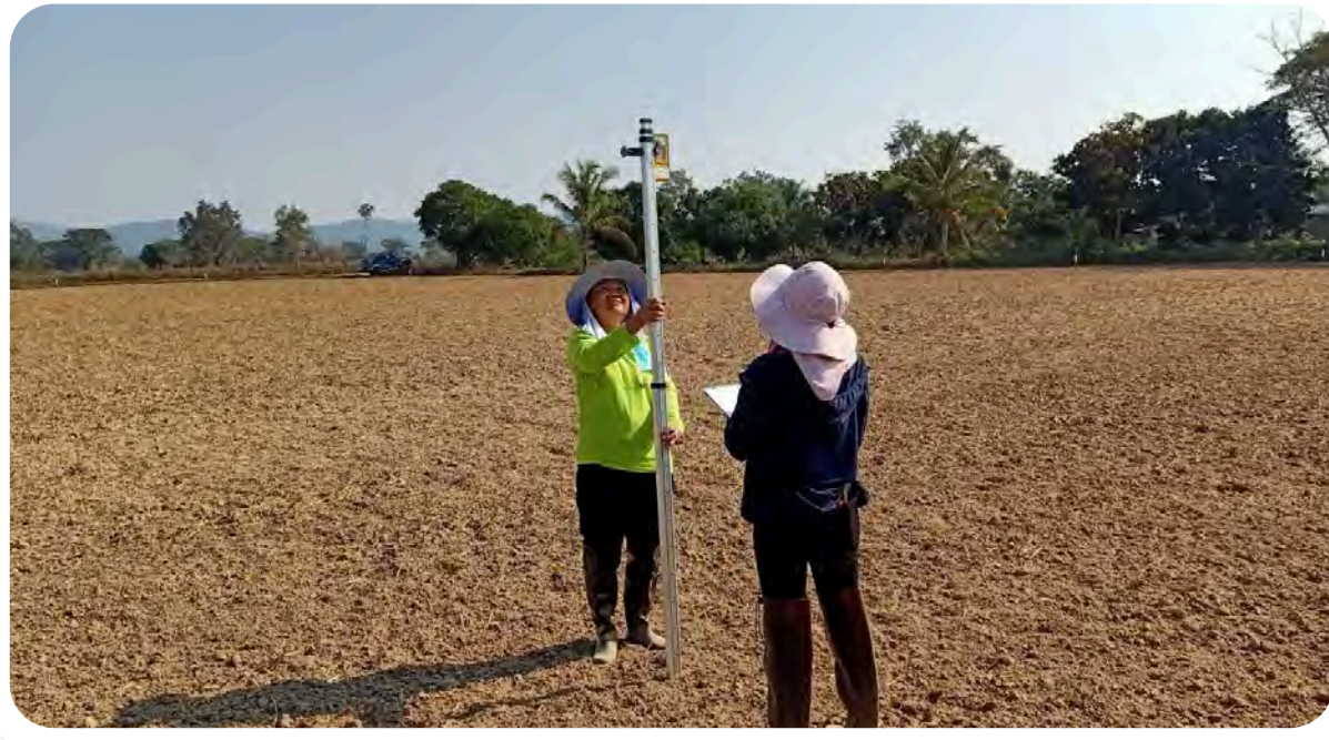
ภาพที่ 3 การสำรวจพื้นที่ วัดความสูงต่ำของหน้าดิน เพื่อคำนวณค่าเฉลี่ยความสูงของแปลง
