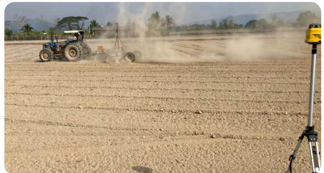
ภาพที่ 4 การปรับระดับพื้นที่นาด้วยเลเซอร์ (LLL)
