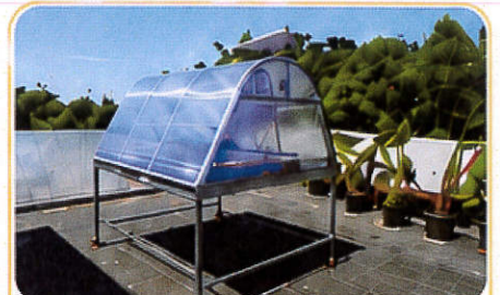
ระบบอบแห้งขนาดเล็ก ขนาด 1.5 x 2.00 เมตร
