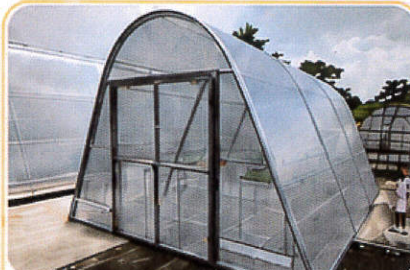
ระบบอบแห้งครัวเรือน ขนาด 4.6 x 6.40 เมตร
