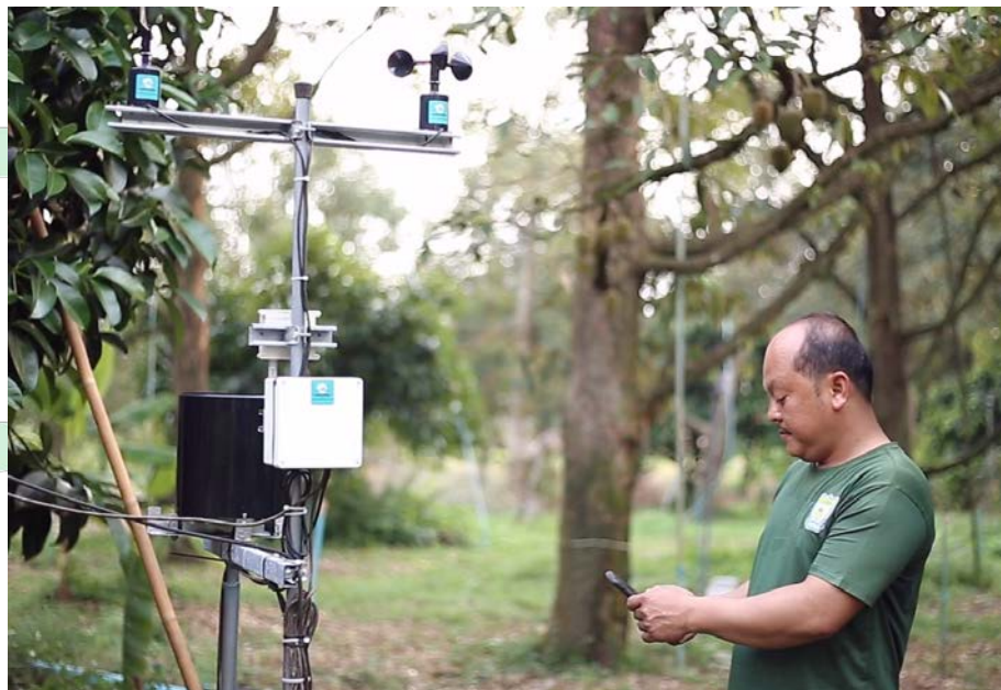
รูปภาพ : ระบบตรวจวัดสถานะแวดล้อมด้วยเทคโนโลยี IoT (WiMaRc)
