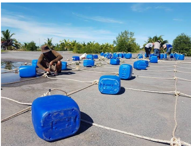
ภาพที่ 15 การผูกกลลอนกับตารางของแพเชือก
