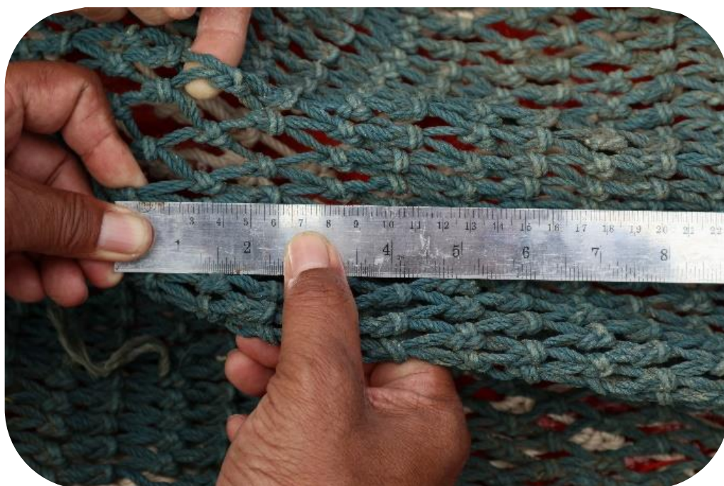
ภาพที่ ๓๓ ลักษณะการวัดตาอวนกันถูง
