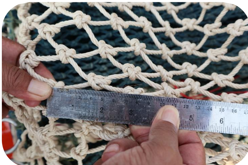
ภาพที่ ๓๔ ลักษณะตาอวนรอกันถุงที่จะต้องทำการวัด
