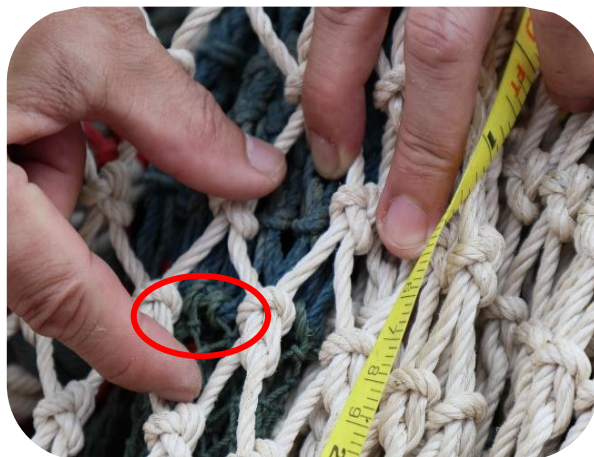
ภาพที่ ๓๑ จุดที่มีการเย็บอวนกันถุงเพื่อเชื่อมต่อกับตาฟริของตัวอวน (เช่นเดียวกับภาพที่ ๑๕) ที่ถูกคลุมด้วยอวนรองกันถุง
