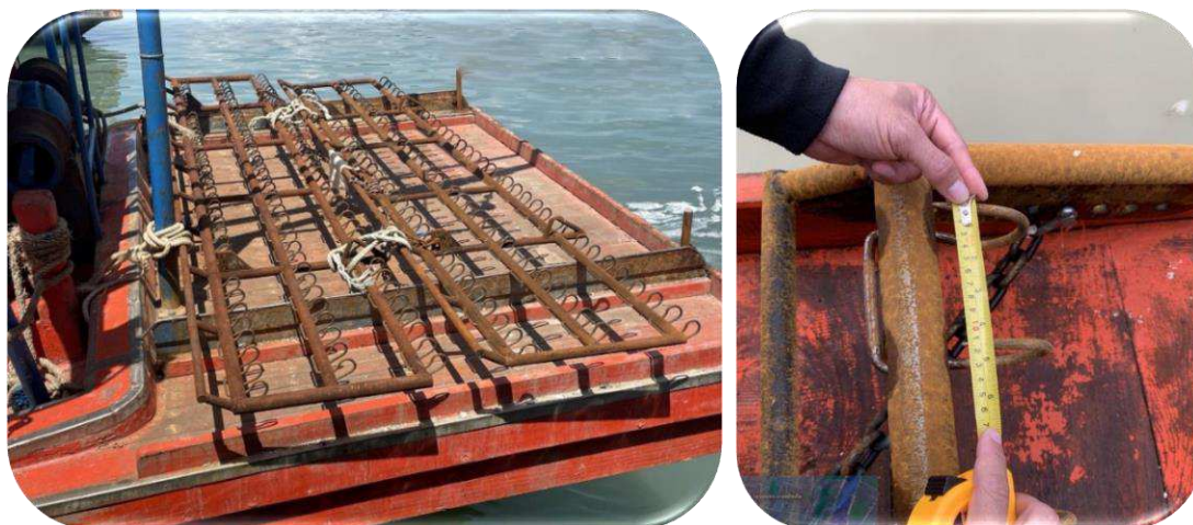
ภาพที่ ๔๐ ลักษณะของคราดปลิงทะเลแบบตะแกรงตะขอ
