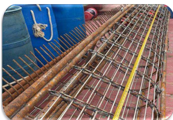
ภาพที่ ๓๘ ลักษณะของคราดปลิงทะเลแบบตะแกรงซี่คราด
