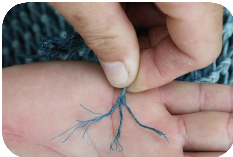
ภาพที่ ๑๙ ลักษณะของเนื้อมานก้านถุง ๑ เส้น ที่คื้อออก
