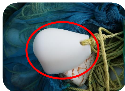
ภาพที่ ๗๘ ลักษณะของเครื่องมือลอบหมึกสายเปลือกหอยเทียม (พลาสติก)
