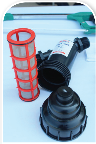
ภาพที่ 41 กรองเกษตรแบบตะแกรง ไล้กรองสีแดงความละเอียด 120 Mesh
