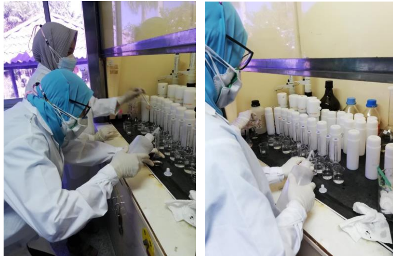
การปรับปริมาตรของสารละลายที่ย่อยได้เพื่อนำไปวิเคราะห์หาปริมาณโลหะหนัก
