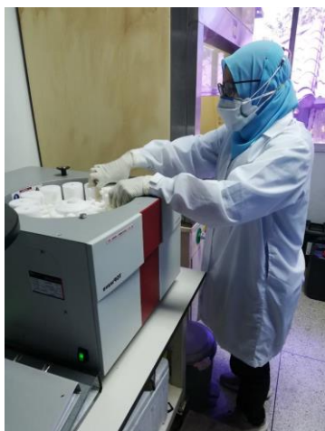
การย่อยตัวอย่างสัตว์น้ำด้วยเครื่องย่อยตัวอย่าง
