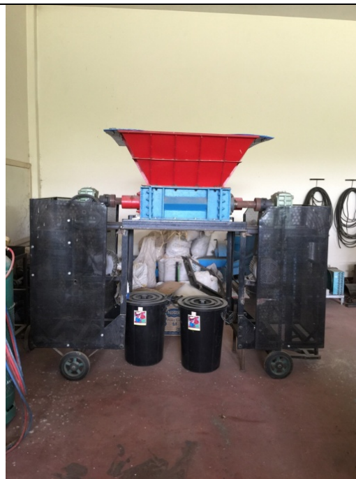
รูปที่ 3 ตัวอย่างเครื่องบดย่อยวัตถุดิบ(ขยะและเศษไม้ซิวมวล)
